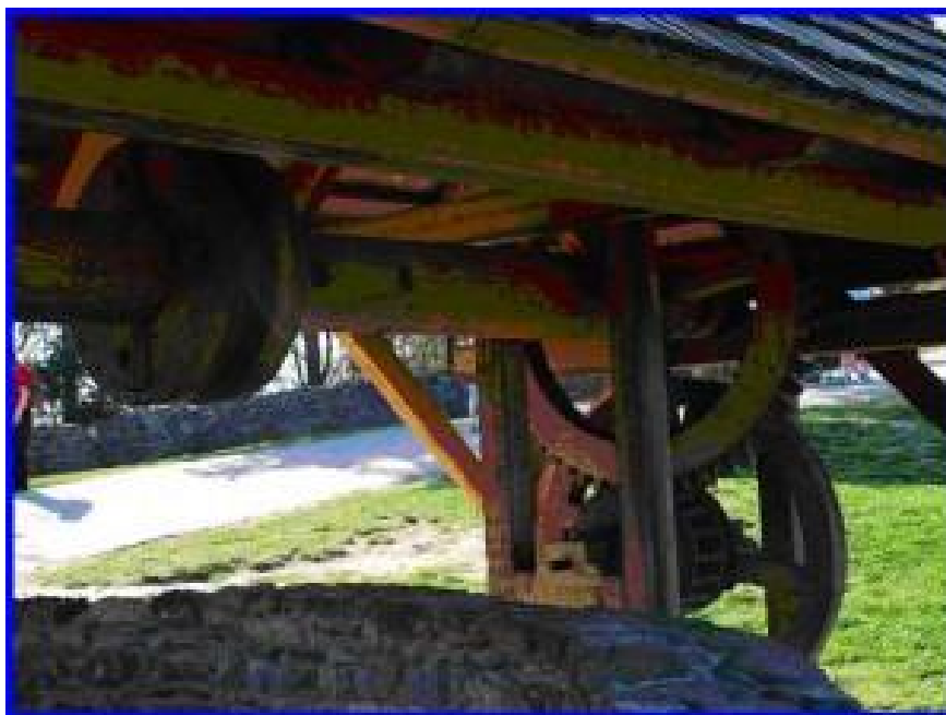
Obrázek Využití kola ve středověku (mechanismus umožňující vyzvednutí nádoby s vodou ze studně)
