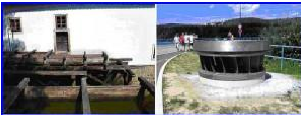
Obrázek Dva typy využití energie vody: vodní kolo a turbína
