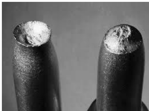
Obr.1.Houževnatý lom na válcovém vzorku
