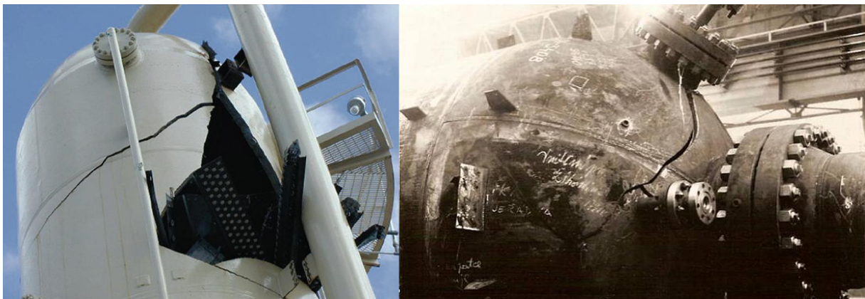
Obr.8. Křehký lom na tlakových nádobách
