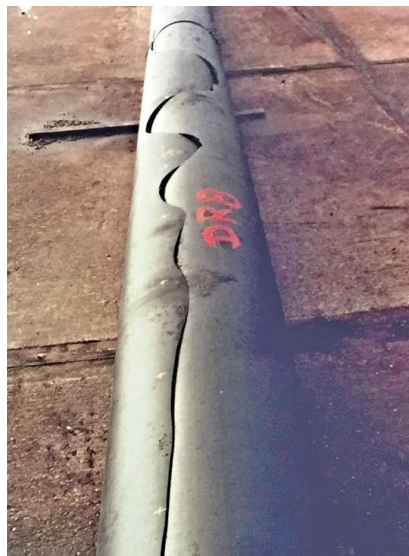
Obr.10. Křehký lom na trubce
