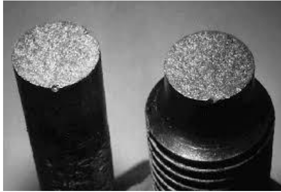
Obr.6. Křehký lom na válcovém vzorci. Je zde vidět i iniciační místo trhliny
